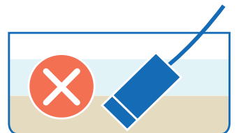
Abbildung 2: Pumpenmontage, Pumpe darf nicht im Schlamm liegen
