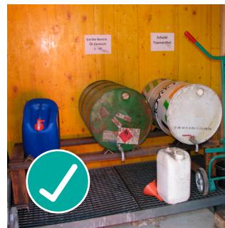
Lagerung mit Auffangwanne
